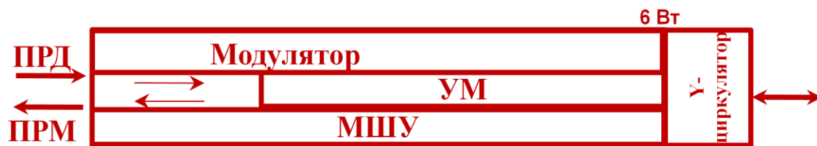
б) одномодульная конструкция для цифровой АФАР
