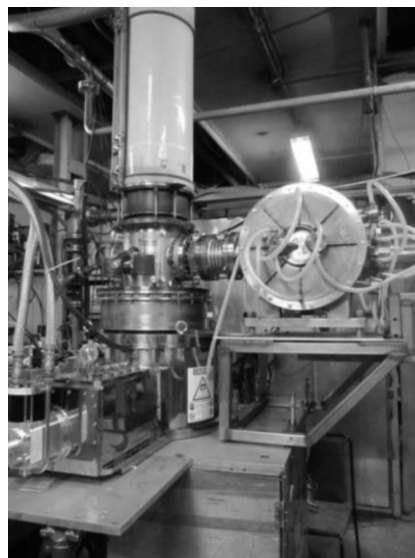
Рисунок 1. Гиротроны для ИТЭР в испытательных стендах со сверхпроводящими магнитами фирм CRYOMAGNETICS (USA) и JASTEC (Japan)
