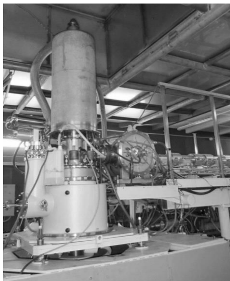
Рисунок 1. Гиротроны для ИТЭР в испытательных стендах со сверхпроводящими магнитами фирм CRYOMAGNETICS (USA) и JASTEC (Japan)
