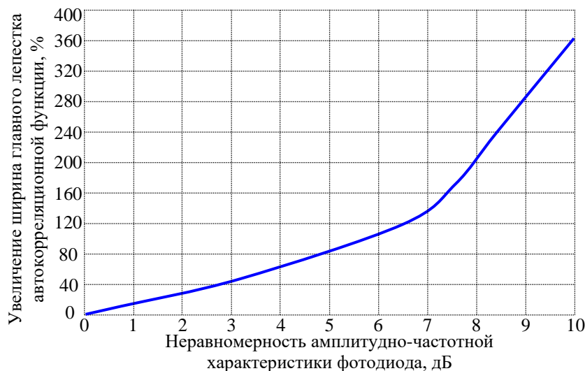
Рис. 3. Зависимость ширины огибающей главного лепестка автокорреляционной функции ЛЧМ-сигнала с полосой 10 ГГц и частотно-временной базой 10^4 от величины неравномерности амплитудно-частотной характеристики фотодиода
