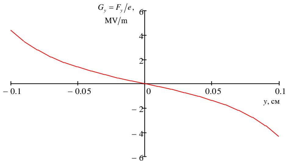
Рисунок 3. Напряженность поперечного поля в зависимости от смещения частицы от оси
