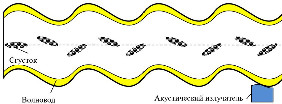
**Рисунок 4.** Колебания хвостовой части сгустка в изогнутом волноводе
