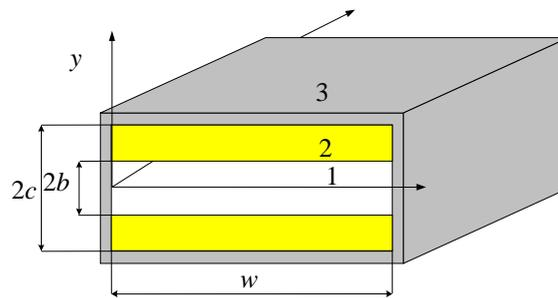
Рисунок 2. Прямоугольная ускорительная структура
