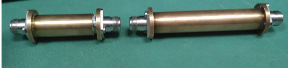
Рисунок 1. Измерительные коаксиальные оснастки со смонтированными разъемами N-типа.
