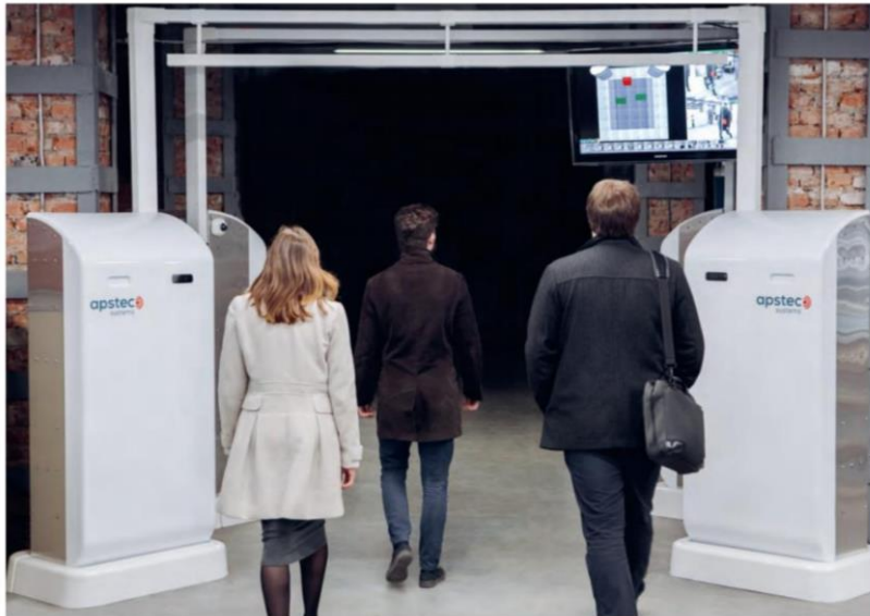
Рисунок 1. Многопозиционная микроволновая досмотровая система компании Apstec Labs
