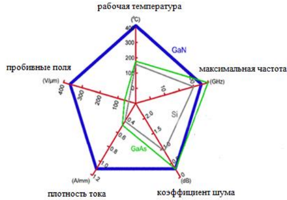
Рисунок 1. Сравнение предельных характеристик приборов на основе нитрида галлия, кремния и арсенида галлия [3]
