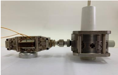
Рисунок 13. Магнетрон с быстрой перестройкой
