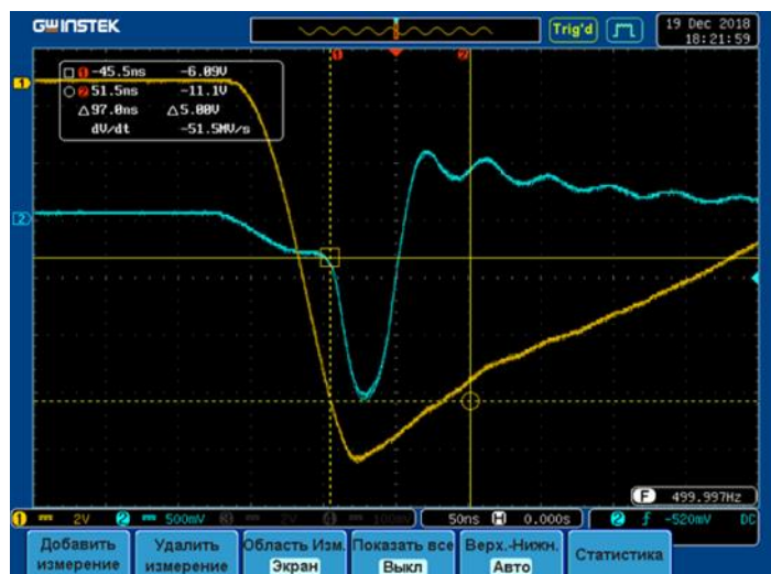
Рисунок 2. Осциллограмма импульсов тока и напряжения модулятора
